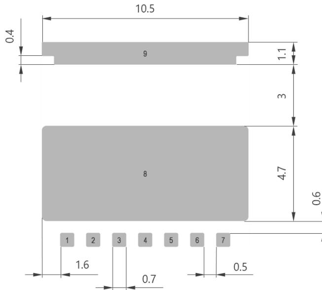
Figure 3 DHDFN footprint (figures in mm)
